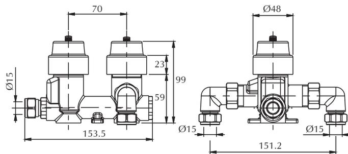
VANNE THERMOSTATIQUE À DOUBLE COMMANDE POUR UNE SEULE SORTIE D'EAU
